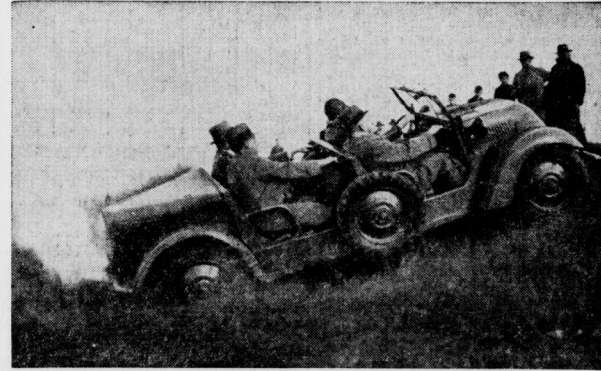
Geländewagen mit Vierradantrieb. Ein bemerkenswerter Geländewagen wurde in Berlin vorgestellt. Das Auto hat Wasserrad-antrieb, vorn und hinten einen Zweitaktmotor von je 600 Kubikzentimeter Inhalt, mit Vorkühlung, und ist so gebaut, daß es alle Unebenheiten im Gelände mühelos überwindet. Stellhänge werden, wie man sieht, trotz vier Mann Besatzung von dem Geländewagen glatt genommen, und selbst enge Trichter bilden keine Schwierigkeiten. Je nach der Beschaffenheit des Geländes wird das Fahrzeug mit dem vorderen oder hinteren Motor oder mit beiden Motoren gleichzeitig angetrieben. (Scherl-Bilderdienst-M.)
