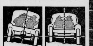
Schmale Spur und nicht einzeln abgefederte Räder begünstigen die Neigung des Aufbaues bei fahrlässigen Straßen.
