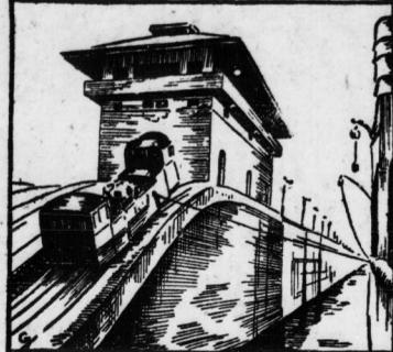
Eine der drei elektrischen Lokomotiven im Panama-Kanal, die durchschleusende Schiffe helfen muß ein.
