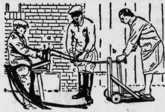
Der Ausziehwagen besteht aus einer auf einem fahrbaren Gestell montierten Kurbel, die an ihrem Ende einen Haken trägt. Ferner gehört zu der Einrichtung noch eine sogenannte Hebe (c) in Form eines Holzkreuzes.
