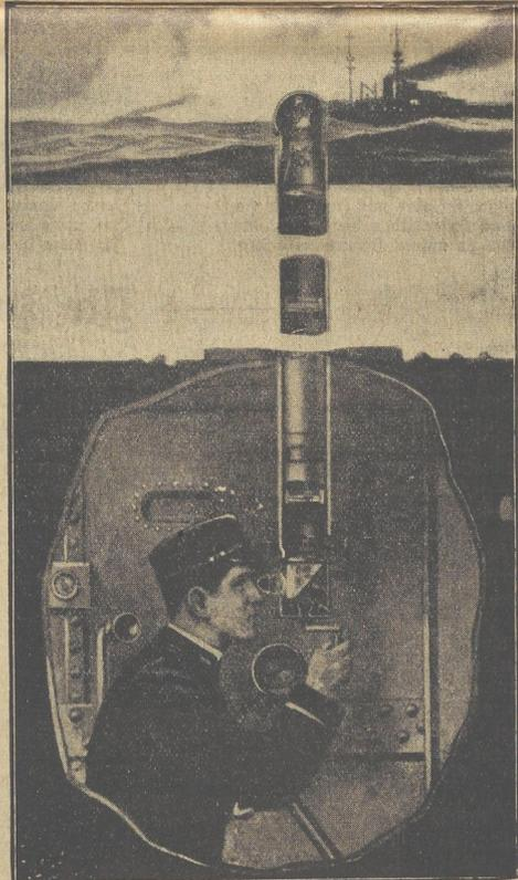
Das Periskop der Unterseeboote. Nach englischer Darstellung. Das Periskop ist das sogen. Sehrohr, mit dem der Führer des Unterseebootes bei der Fahrt unter Wasser die Oberfläche des Wassers überschaut und das Vorhandensein feindlicher Schiffe feststellen kann.
