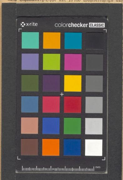
Die farbigen Quadrate dienen zur Farbkorrektur und zur Messung der Farbabweichung. Die Skala unten zeigt die Abmessungen in Millimetern.
