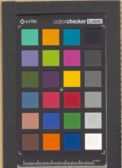
Das Bild zeigt eine Farbkalibrierungstabelle (ColorChecker) mit einer Rasterstruktur aus farbigen Quadraten. Die Tabelle ist beschriftet mit 'xrite colorchecker CLASSIC'. Darunter befindet sich eine Maßstablinie in Millimetern. Die Tabelle dient zur Kalibrierung von Bildern und zur Sicherstellung der Farbtreue in der Reproduktion.
