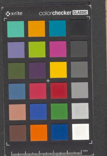
Das ist ein Bild eines Farbkorrektur- und Maßstabes. Es zeigt eine Reihe von farbigen Quadraten (rot, gelb, grün, blau, magenta, cyan, grau) und eine Skala in Millimetern am unteren Rand. Die Beschriftung oben lautet 'xrite colorchecker CLASSIC'.
