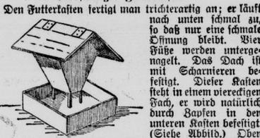
Den Futterkasten fertigt man leichtfertig an; er läuft nach unten schmal zu, so daß nur eine schmale Öffnung bleibt. Vier Fische werden untergenommen. Das Dach ist mit Scharnieren befestigt. Dieser Kasten steht in einem vierseitigen Neß, er wird natürlich durch Rapsen in den unteren Kasten befestigt. (Siehe Abbild.) Oben schließt man das Futter ein. Es wird von selbst nachfallen. Die hohe Einfassung des unteren Kastens verhindert das Vertreten des Futters.
