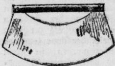
Abb. 2. Gerberhalbmund zur Bearbeitung kleinerer Felle.
