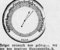
Der kleine Belger verneint den gestrigen, der große Zeiger den heutigen Barometerstand.
