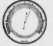
Der kleine Zeiger verweist den gestrigen, der große Zeiger den heutigen Barometerstand.
