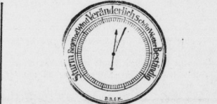
Der kleine Zeiger vermerkt den gelisteten, der große Zeiger den heutigen Barometerstand.
