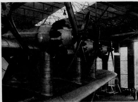
Sinteransicht des Motorendecks. Es sind immer je zwei Motoren zusammengepackt.
