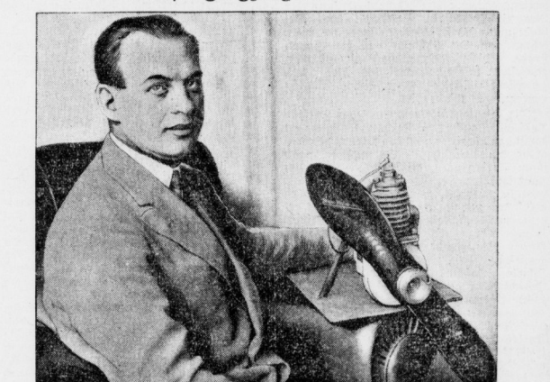
Segelflieger Hans Richter mit dem von ihm konstruierten Kleinmotor. Der erfindungsreiche Segelflieger Hans Richter hat einen Motor für Flugzeuge konstruiert, der im ganzen nur 35 Kilogramm wiegt. Die Propellerlänge beträgt entsprechend nur 60 Zentimeter. Richter hat mit diesem Kleinmotor bereits mehrere kurze Flüge zurückgelegt und beabsichtigt, da mit demnächst auch zu einem Ueberlandflug zu starten. Die Leistung des Motors beträgt 1 PS.
