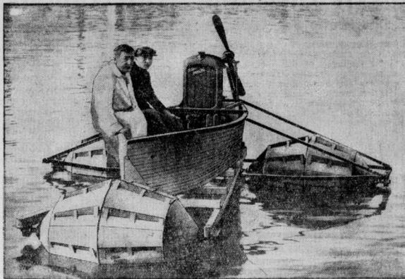
Der französische Konstrukteur Gelerien (in weißem Mantel) auf seinem neuartigen Propellerboot bei der ersten Probefahrt. Auf der Seine bei Paris wurde ein neuartiges Propeller-Schnellboot vorgeführt, das durch einen Motor von nur 9 PS angetrieben wird und eine Geschwindigkeit von 140 Kilometer je Stunde erreichen soll. Besonders auffällig sind die rotierenden Schwimmerkörper in Trommelform.
