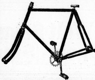
mit ungelöthetem Rahmen, automatischer Bremse, Columbia-Kugellagern
