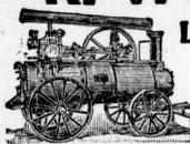
Brennmaterial ersparend. **LOCOMOBILEN** mit ausziehbarer Röhrenkessel von 4—300 Pferdekraft. — dauerhafteste und zuverlässigste — Betriebsmaschinen für Industrie und Landwirtschaft.
