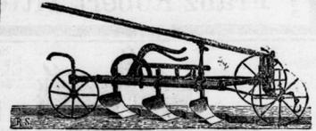
mit erhöhtem Pflugkörper von **Stahlguss** und **Stahlgründel**, welche ein Stopfen am Gründel vollständig ausschliessen. Ferner besitzen sowohl Stahlgusskörper als Stahlgründel trotz des erheblichen Mindergewichtes eine um 50 bis 100 Procent grössere Widerstandsfähigkeit als Körper aus Gusseisen und Eisengründel, was bei grosser Boden Härte von allergrösstem Vortheile ist.
