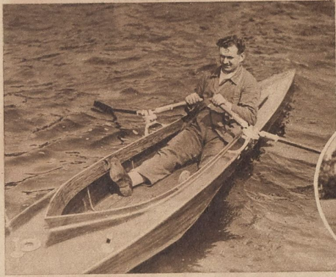
Rudere mit Blick nach vorn! Ein neuer Ruderapparat, der auf der Allgemeinen Wassersport-Ausstellung in Potsdam gezeigt wird. Durch die Anordnung der Riemen wird das Rückwärtsgehen vermieden. Ein weiterer Vorteil soll darin liegen, daß die Tiefe des Eintauchens der Blätter durch eine Stellschraube regulierbar ist. Für den Nichtsportler ein geeignetes Fahrzeug R.
