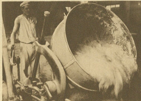
Blick in die größte Großbäckerei Deutschlands, die täglich mit 46 Backöfen etwa 50000 Brote in Berlin liefert. Der Betrieb ist in hygienischer Hinsicht vollkommen einwandfrei; kein Qualm und Staub dringt in die Fabrikräume. — Bild links: Teignetmaschine. — Bild rechts: Große Backöfen mit zwei übereinander liegenden Backanlagen Preis-Photo
