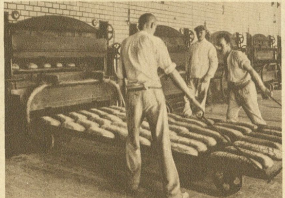
Blick in die größte Großbäckerei Deutschlands, die täglich mit 46 Backöfen etwa 50000 Brote in Berlin liefert. Der Betrieb ist in hygienischer Hinsicht vollkommen einwandfrei; kein Qualm und Staub dringt in die Fabrikräume. — Bild links: Teignetmaschine. — Bild rechts: Große Backöfen mit zwei übereinander liegenden Backanlagen Preis-Photo
