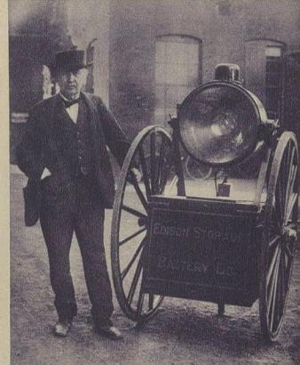
Edison und sein „Leichter Akkumulator“ Die im Gestell des Karrens untergebrachte Akkumulatorenbatterie genügt, um den darüber befindlichen Scheinwerfer derart mit Strom zu speisen, daß eine Lichtstärke von drei Millionen Kerzen erreicht werden soll.
