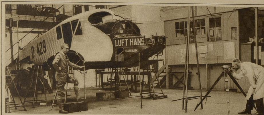
Ausrichten einer Junkersmaschine
