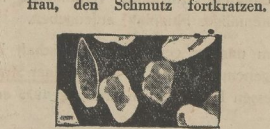
Grobes Scheuermittel feucht, 40 mal vergrüßert. Die spitzen und groben Mineralpulver verursachen Kratzer.
