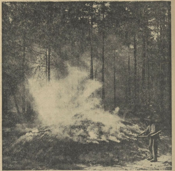
Der schwelende Meiler muß von Zeit zu Zeit angestochen werden, um Luft zuzuführen
