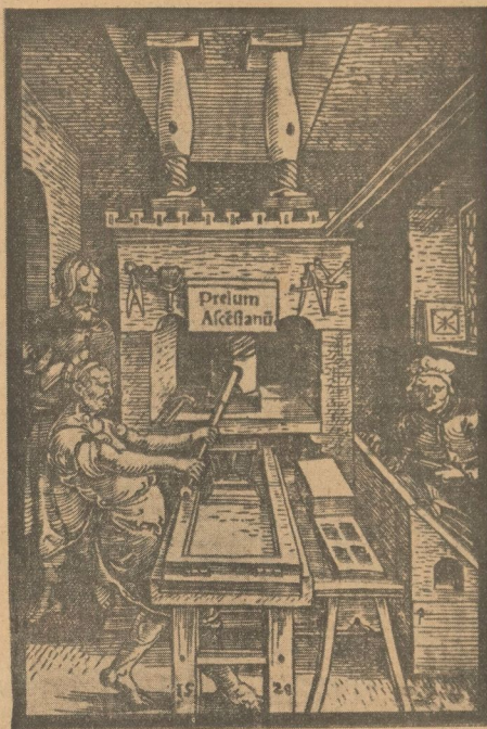
Dieses Druckerellfirmen-Zeichen ist eine der ersten Darstellungen der Buchdruckerpresse. Deutlich sind alle Einzelheiten: Stützen, Querbalken, Spindel mit Bengel, Tiegel usw. zu sehen.
