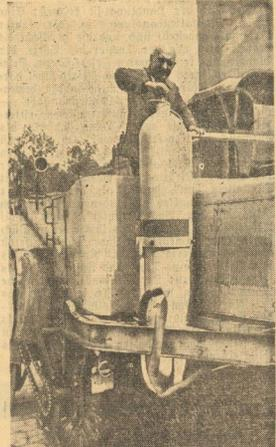
Links: Müllabfuhr (Gaulse) An den großen Kerosinmaschinen der städtischen Straßenreinigung sind die Methan-Gas-Stahlflaschen besonders gut sichtbar
