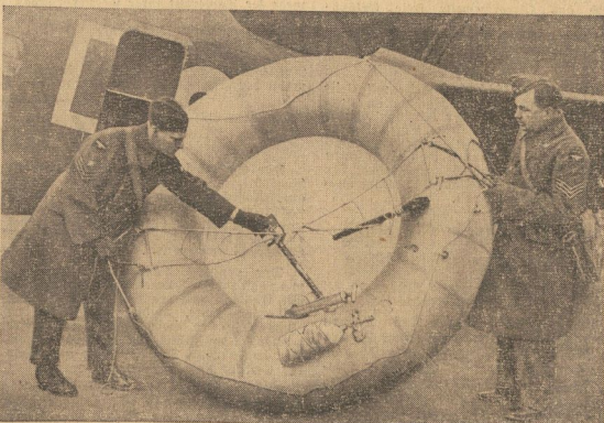
Wien: Associated Press, Sonder-Korrespondent-R. Das Schlauchboot eines britischen Flugzeuges Wie berichtet, wurden mehrere britische Flieger nach der großen Luftschlacht bei Helgoland in einem dieser Boote auf der Nordsee treibend gefunden. Die Luftpumpe zum Aufblasen ist deutlich am unteren Ende des Ringes zu erkennen.
