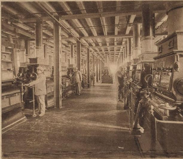
**Mühlromantik?** Kein Mühlenrüttel dreht sich mehr im Wind; das Geflapper der „Mühle am rauschenden Bach“ hat aufgehört. Sie sind beide nicht mehr „zeitgemäß“. Großbetriebe mit dampfenden Maschinen sind an ihre Stelle getreten, um den gesteigerten Bedarf schneller und rationeller zu befriedigen. — Blick auf den Walzenboden einer Großmühle mit umfangreichen Maschinenanlagen S.B.D.
