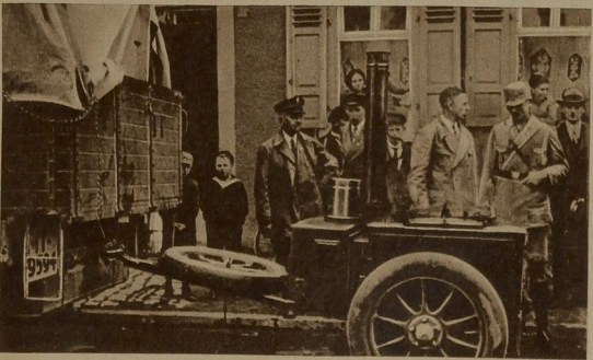
Eine an die Transportfahrzeuge der Technischen Nothilfe anhängbare Kochvorrichtung ermöglicht in Katastrophengebieten rasche Verpflegung der Nothelfer und der obdachlos gewordenen Bevölkerung
