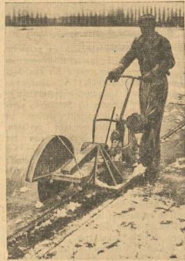
Bei den Eisarbeiten auf einem der Seen im Nordosten der Reichshauptstadt wurde jetzt zum ersten Male diese von dem Berliner Erfinder Rudolf Ortlepp konstruierte Motorkreissäge zum Ausschneiden von Eisblöcken eingesetzt.
