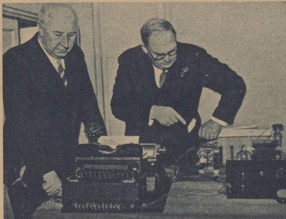
Eine Schreibmaschine, die durch Radiowellen betrieben wird
