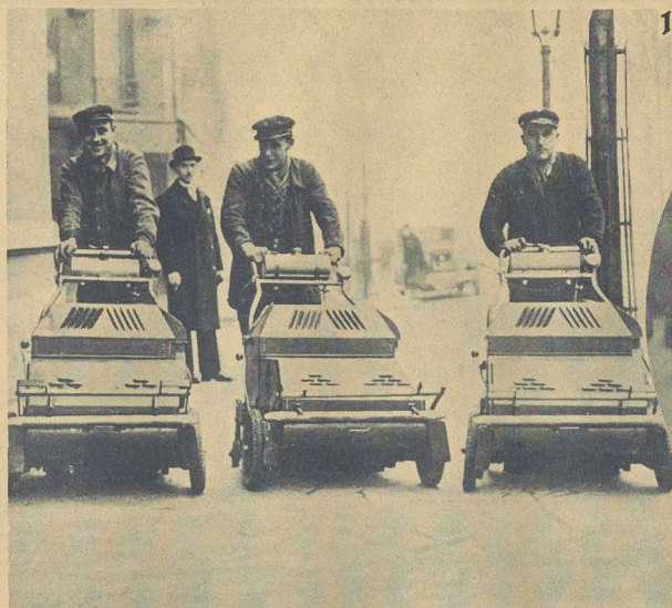
1 Rehrmaschinen. In Paris sind neuerdings Rehrmaschinen für die Bürgersteige eingeführt worden. Sie ähneln Kinderwagen, haben eine Strengevorrichtung und eine durch einen Motor betriebene Bürstenwalze. Der Rehrschutt wird in einem Behälter aufgefangen. [Reystone]
