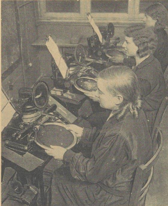
Diesmal werden die Stimmlisten automatisch ausgefüllt. Für die kommenden Reichspräsidentenwahlen werden zum ersten Male die Stimmlisten automatisch ausgefüllt. Für jeden Wahlberechtigten wird eine Metallplatte mit Name und Adresse geprägt, die immer wieder zum Abdruck verwendet werden kann. — Die Prägung der Metallplatten. [Reystone]
