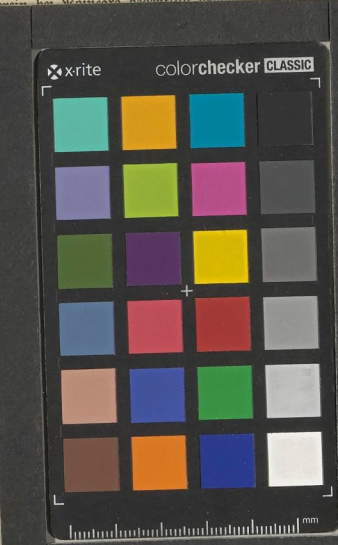
Das Bild zeigt eine Xrite ColorChecker Classic, ein Standardwerkzeug zur Farbkorrektur in der Fotografie. Es besteht aus einer Reihe von farbigen Quadraten, die zur Kalibrierung der Kamera dienen, um genaue Farbwiedergabe zu gewährleisten. Ein Maßband ist ebenfalls an der Unterseite des Charts zu sehen.
