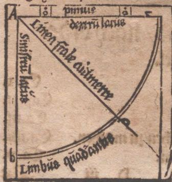
Nun bedeut die lini / a. b. die linck seite am Quadranten / a. c. die rechte b. c. des Quadranten bogen. a. die linia der leyter zum abmessen.
