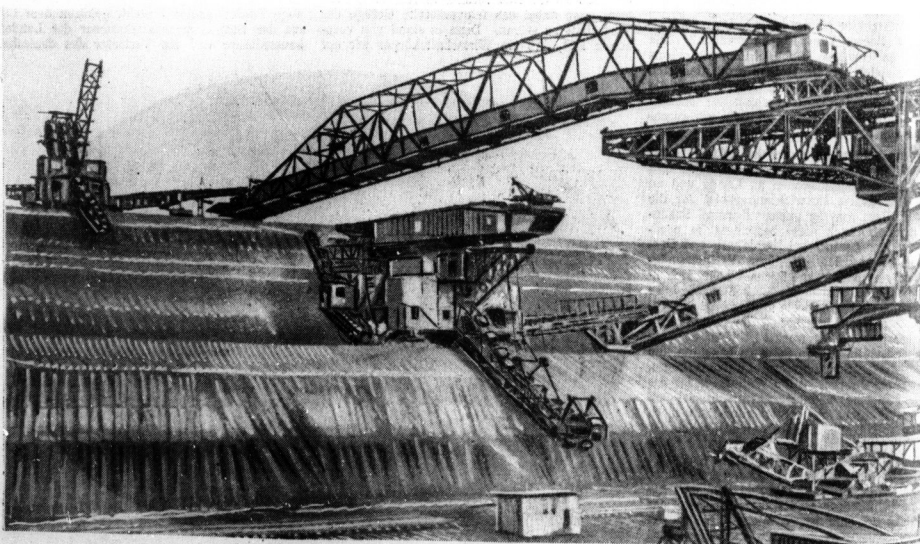
Aus einem Großtagebau im mitteldeutschen Braunkohlengbiet — Stufenweise Abraumgewinnung mit mehreren Baggern über Zubringerbrücken | Aufn. Bergart Abels
