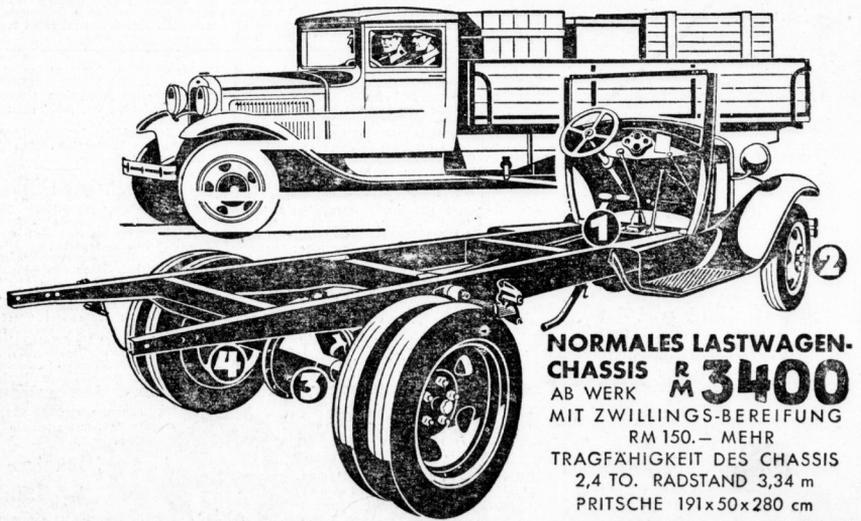
NORMALES LASTWAGEN-CHASSIS R 3400 AB WERK M 3400 MIT ZWILLINGS-BEREIFUNG RM 150.— MEHR TRAGFÄHIGKEIT DES CHASSIS 2,4 TO. RADSTAND 3,34 m PRITSCHEN 191x50x280 cm
