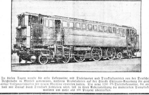
In diesen Tagen wurde die erste Lokomotive mit Dieselmotor und Druckluftantrieb von der Deutschen Reichsbahn in Betrieb genommen, nachdem Probefahrten auf der Strecke Göttingen-Mosbuz die große Leistungsfähigkeit der neuen Maschine erwiesen hatten. Die neue 1200 PS-Diesellokomotive, die anstatt mit Dampf durch Druckluft betrieben wird, soll in ihrer Arbeitsleistung die modernen Dampflokomotiven um mehr als 100 Prozent überbieten.
