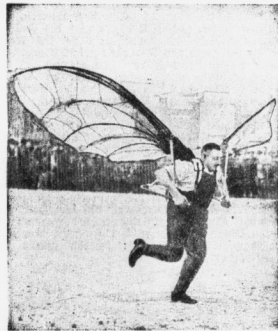
Muskelkraft-Flugzeug eines Pariser Konstrukteurs, das durch Armarkt betätigt werden sollte
