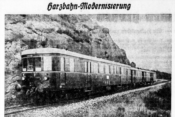
Am gestrigen Tage wurde mit einer Einweihungsfahrt ein neuer Triebwagenzug der Halberstadt-Blankenburger Eisenbahn in Dienst gestellt. Der Zug, den unser Bild hier auf der Strecke zeigt, ist nach modernsten technischen Gesichtspunkten gebaut. Er besteht aus einem Triebwagen, dessen Dieselmotor rund 500 PS zu leisten vermag, sowie aus drei Anhängern, die sich durch besonders leichte Bauart auszeichnen. Wir werden über diesen wichtigen Schritt zur weiteren Modernisierung der Halberstadt-Blankenburger Eisenbahn noch ausführlicher berichten. Aufnahme: Lidemann, Blankenburg
