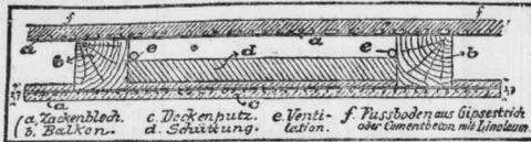
(a. Zackenblech. b. Balken. c. Deckenputz. d. Vertikal-Lon. e. Vertikal-Lon mit Gipsstreich. f. Fussboden aus Gipsstreich.)
