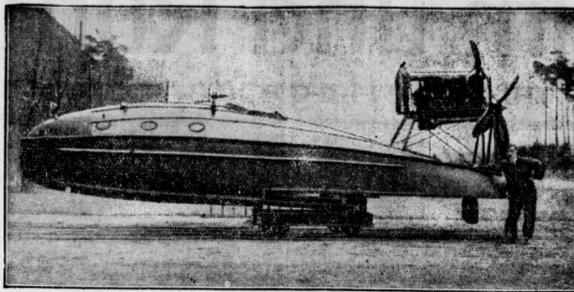
Der Berliner Ingenieur Otto Hellmuth hat ein neuartiges Schnellboot konstruiert, das mit einem Junkers-Flugzeugmotor von 267 PS angetrieben ist, der dem Boot eine Höchstgeschwindigkeit von 100-Stundenkilometern verleiht. Hellmuth will mit seinem Schnellboot in einigen Wochen zu einer Weltreise starten, die über Hamburg, Calais, Gibraltar bis zum Suez-Kanal, von dort nach Schanghai, Tokio bis nach dem amerikanischen Festland und schließlich durch den Panama-Kanal nach New York führen soll.
