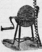
Schleif-Apparat für Mähmaschinen-Messer, welcher das sonst lästige und zeitraubende Schärfen der letzteren sehr bequem u. sehr ermöglicht.
