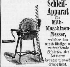
Schleif-Apparat für Mäh-Maschinen-Messer, welches das sonst häufige u. zeitraubende Schärfen der letzteren bequem u. rasch ermöglicht.
